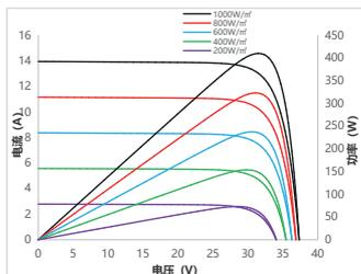
电流-电压曲线 SS8-54HS -410M
